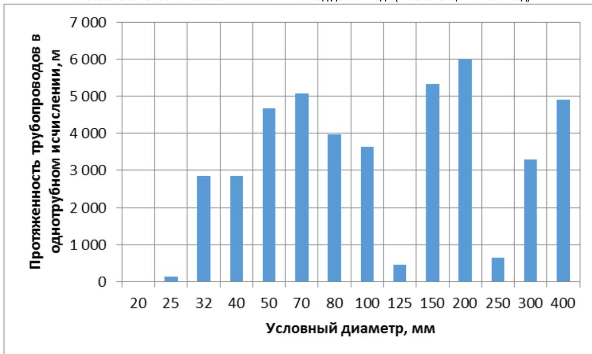
Рисунок 1.2 – Распределение протяженности трубопроводов тепловых сетей от АО «Кыхылская ТЭЦ» по диаметрам
