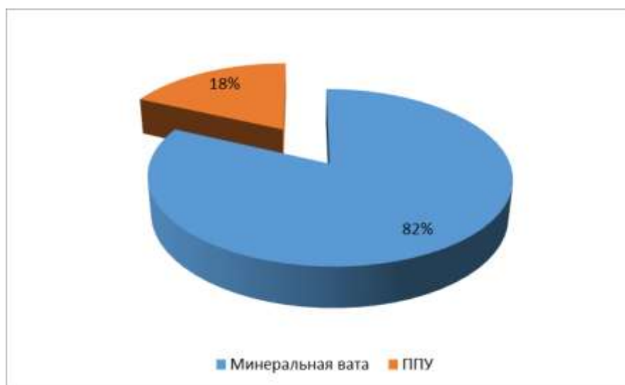
Рисунок 1.4 – Распределение протяженности трубопроводов тепловых сетей от АО «Кызылская ТЭЦ» по видам изоляции
