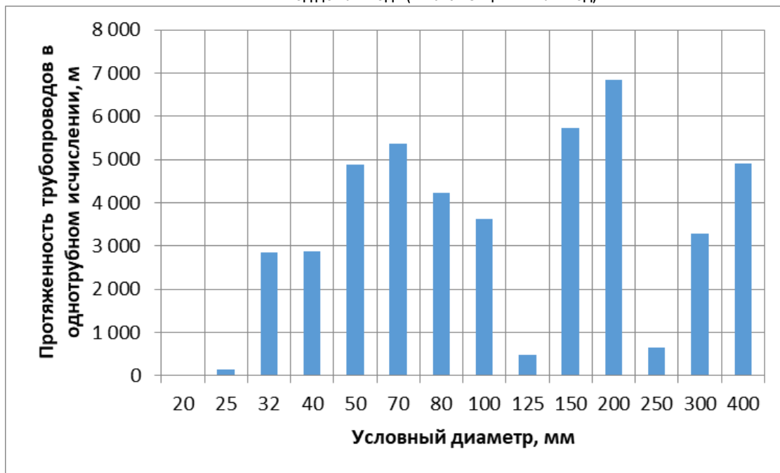
Рисунок 1.2 – Распределение протяженности трубопроводов тепловых сетей от АО «Кызылская ТЭЦ» по диаметрам
