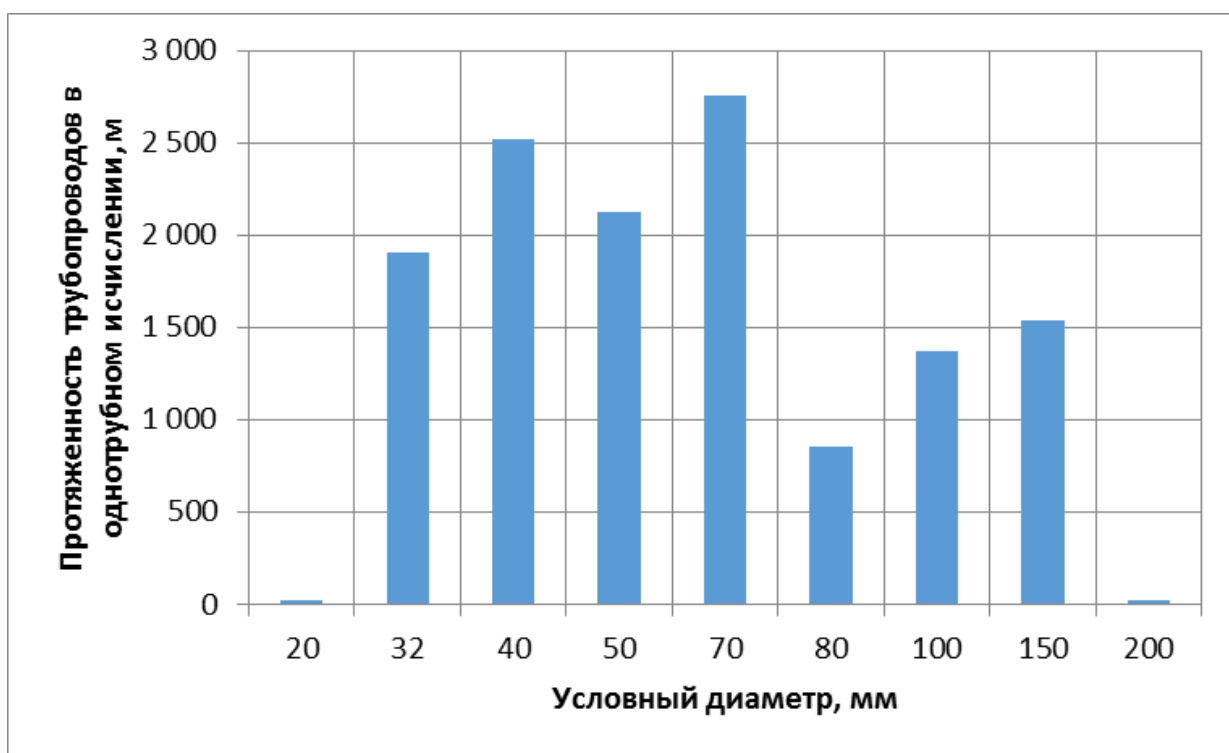
Рисунок 1.5 – Распределение протяженности бесхозных квартальных трубопроводов тепловых сетей отопления в зоне деятельности АО «Кызылская ТЭЦ» по диаметрам
