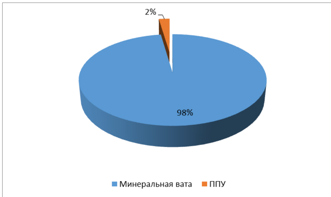
Рисунок 1.8 – Распределение протяженности бесхозяйных квартальных тепловых сетей отопления в зоне деятельности АО «Кызылская ТЭЦ» по видам изоляции
