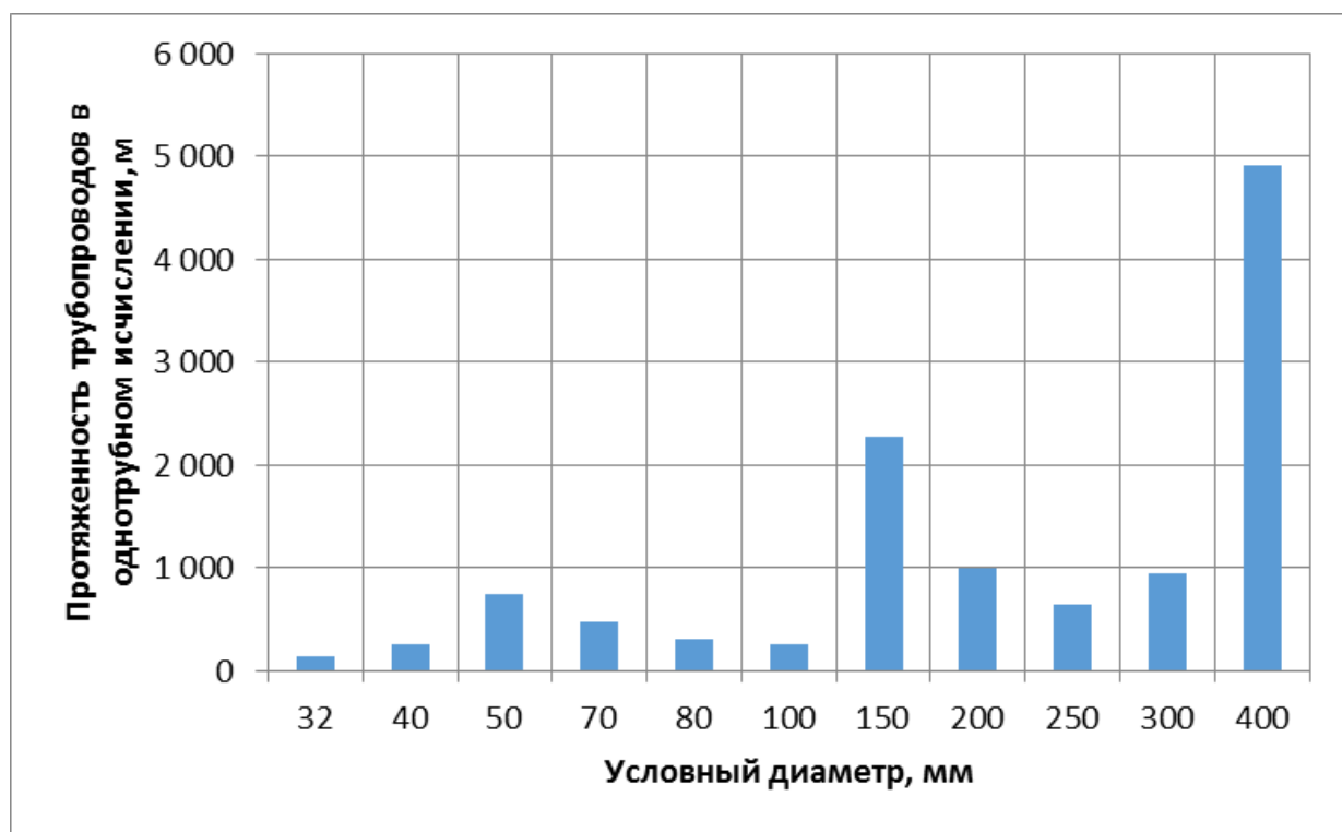
Рисунок 1.4 – Распределение протяженности бесхозяйных распределительных тепловых сетей в зоне деятельности АО «Кызылская ТЭЦ» по диаметрам
