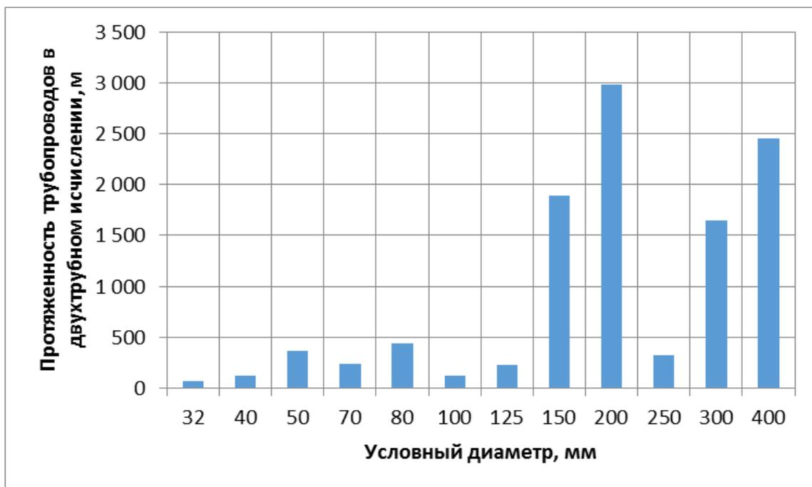
Рисунок 1.3 – Распределение протяженности распределительных трубопроводов тепловых сетей отопления в зоне деятельности АО «Кызылская ТЭЦ» по диаметрам
