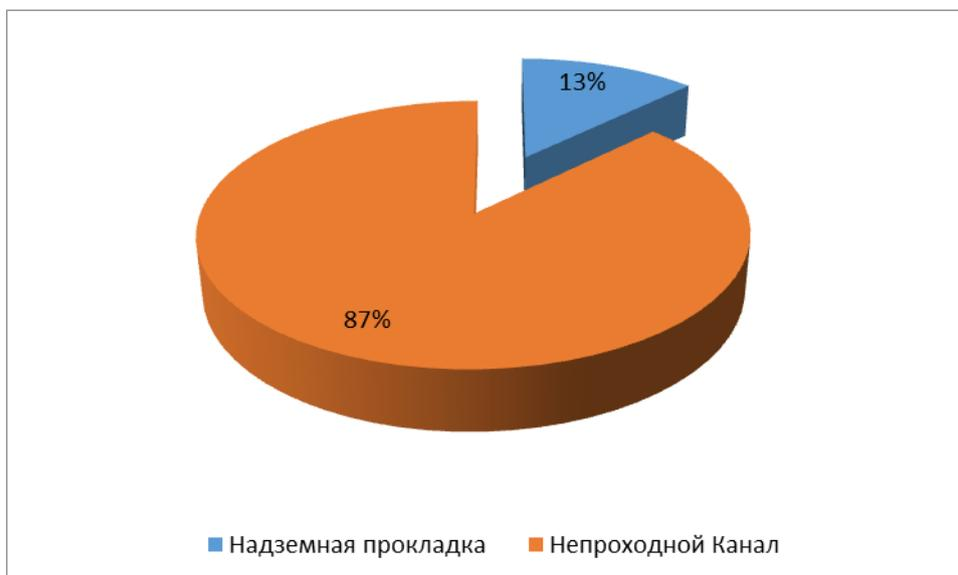
Рисунок 1.5 – Распределение протяженности распределительных трубопроводов тепловых сетей отопления в зоне деятельности АО «Кызылская ТЭЦ» по способу прокладки
